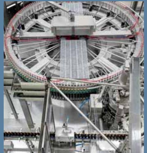
Füller Mecafill VKP-V mit 176 Füllventilen
